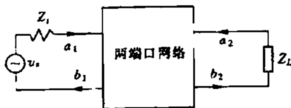
图 5.18 两端口网络, 入射波( a_1, a_2 ), 反射波( b_1, b_2 ), 它们用于表示 s 参数的定义
